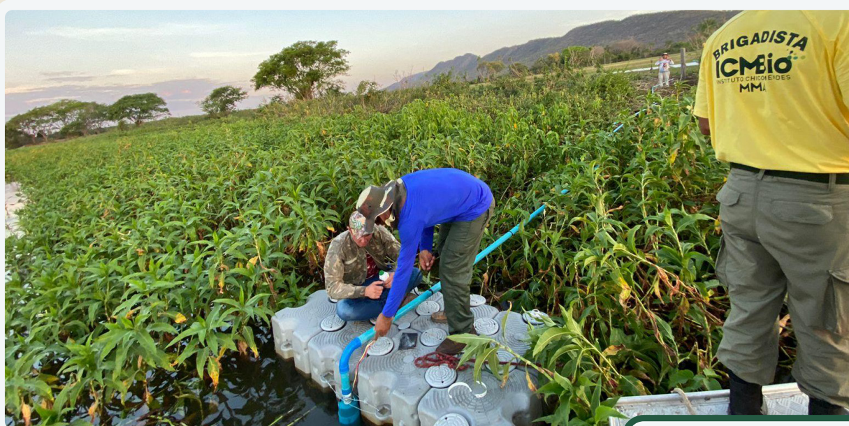
Bomba de captação de água
